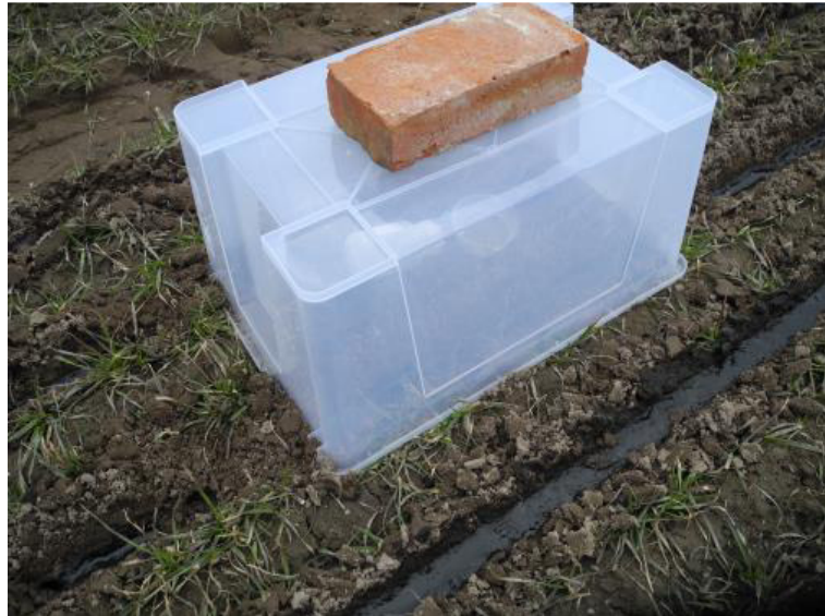
Abb. 1: Ammoniakemissionsmessung mit geschlossener Kammermethode und Schwefelsäure, (Gülzow, 2013 - 2014)
