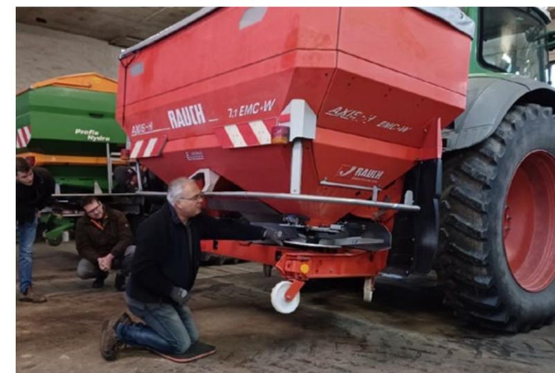
**Kontrolle von Verschleiß und die Ausrichtung der Streuscheufeln.**
